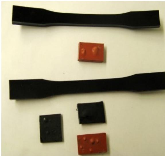
**FIGURE 9 – SOFT GASKET BLISTERS ALONGSIDE PE DUMBBELLS WITHOUT BLISTERS**
