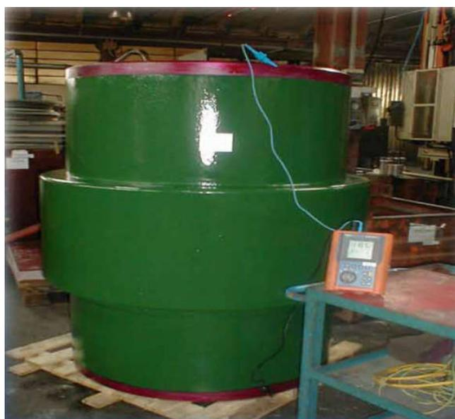
**Figura 10 - Teste de isolamento Elétrico**
