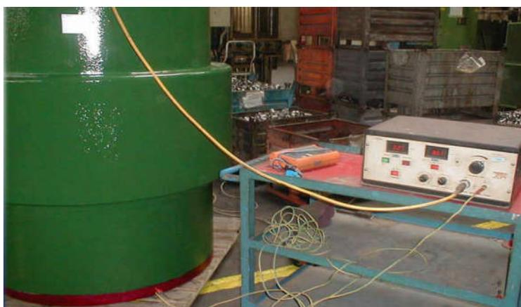
**Figura 9 - Teste de Rigidez Dielétrica**
