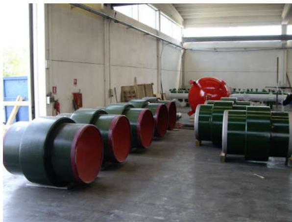
**Figura 3 - Juntas de Isolamento Elétrico Monobloco**
