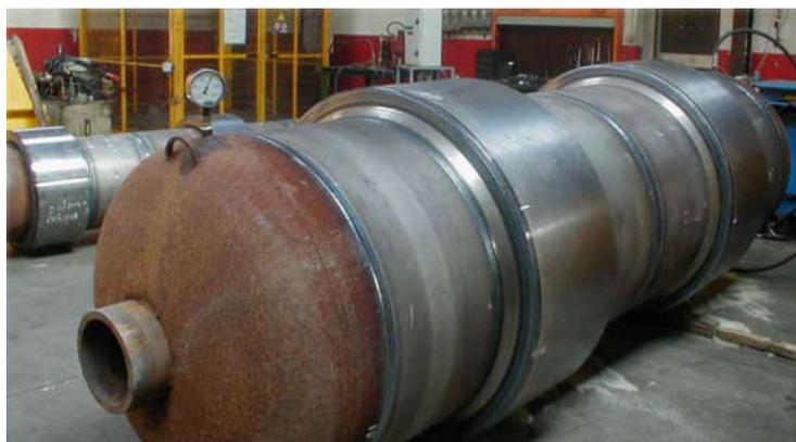
**Figura 8 - Teste Hidrostático de Pressão**
