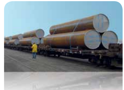
PE Fiber Sheets on Ø 60" pipes
