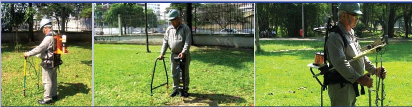
O método de Pearson é uma técnica que consiste em determinar falha de revestimento, através da medição de um gradiente de potencial gerado na superfície devido a saída de corrente nos defeitos do revestimento.
